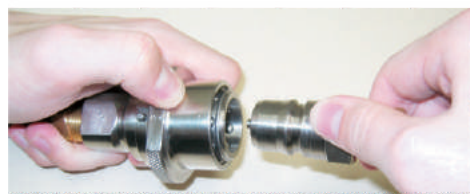
Retração da Capa (luva) de Acionamento
